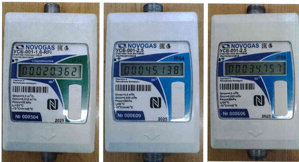
Рисунок 1.1 – Фотографии общего вида счетчиков газа бытовых ультразвуковых УСБ-001 (изображение носит иллюстративный характер)
