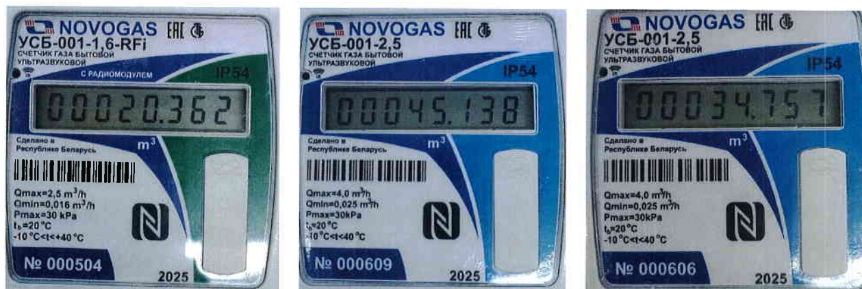
Рисунок 1.2 – Фотография маркировки счетчиков газа бытовых ультразвуковых УСБ-001 (изображение носит иллюстративный характер)
